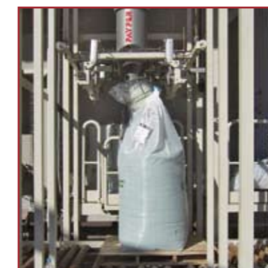
Estación de llenado de big-bags 1 asa Big-bag filling station 1 handle
