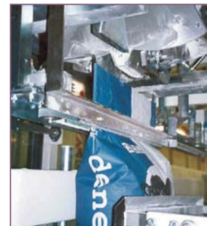
CSA 75 Sistema motorizado de arrastre del saco Sack guiding system through motorised belts
