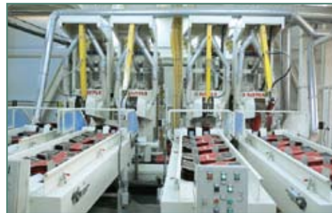
Installation en ligne (4 unités), avec magasins multiples Absackanlagen (4 Einheiten), mit Mehrfachlagerung
