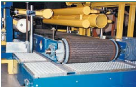
Tapis à maille avec système de récupération de produit Netzförderband mit Produktabnahmesystem
