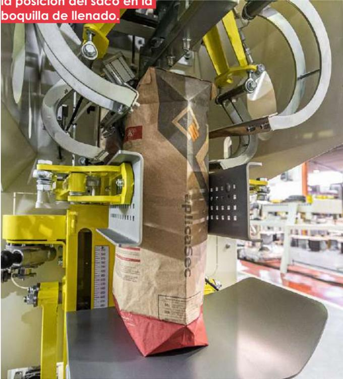
Instalación de alta producción: 4 PFG-10 ensacadoras de válvula trabajando en línea. Producción hasta: 2.200 sacos / hora
