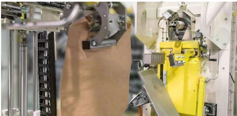
Ahora han instalado una solución ALL-IN-ONE con una ensacadora y sistema de paletización integrado. Los sacos de 25 kg se llenan, sellan y paletizan con este robot compacto (4 x 6 m). El operador rellena el almacén de sacos vacíos y recoge los palets cargados para su envío.
