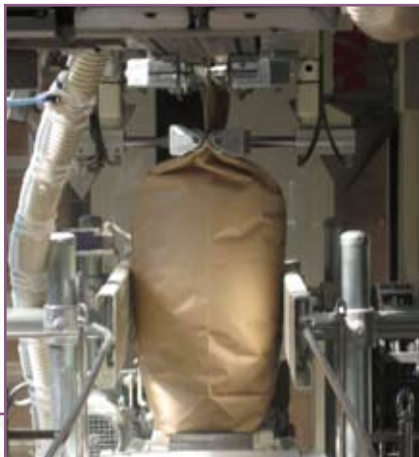
CSA 75 Extracción aire residual Extraction of residual air
