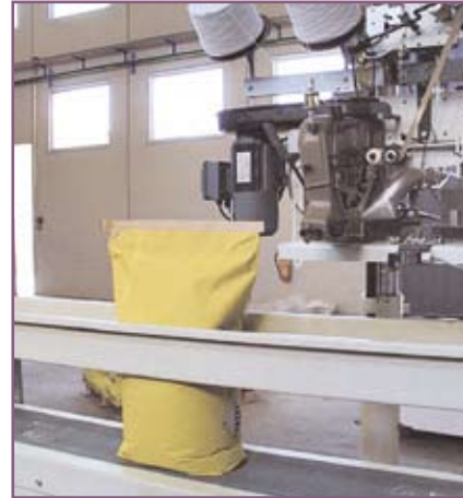
CSA 95 Acabado final del saco lleno Final locking of filled bag
