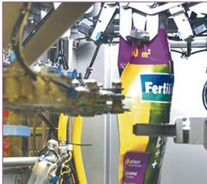
CSA 105 Manipulación de sacos con fuelles laterales Handling of side-gusseted sacks
