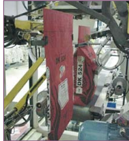
CSA 100 Colocación y estirado del saco Bag placing and stretching
