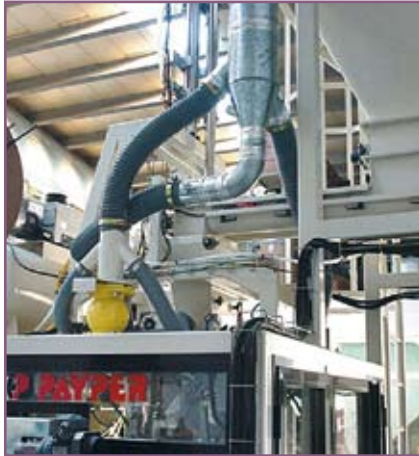
CSA 75 Système d'aspiration de la poussière Staubabsaugsystem
