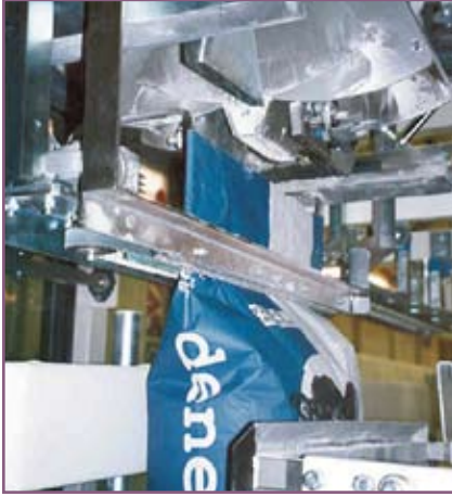
CSA 75 Système motorisé entraîneur du sac Motorisiertes Sackführungssystem
