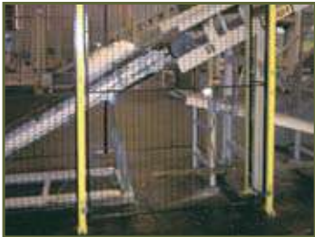
Rehuse automático de los sacos en la cinta de transporte Automatic rejecting system of the bag in the belt conveyor
