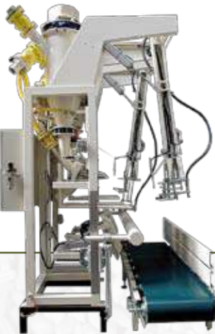
EFI Ensacheuse par injection d'air sac à valve EFI Sackabfüllgerät mit Luftzuführung
