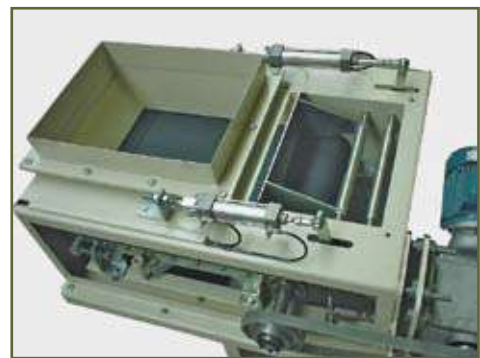
Détail du système de dosage par tapis transporteur. Clapettes de réglage du grand et petit débit Ausschnitt Dosiersystem mittels Transportband: Durchlaufregulierung - und Verschlussklappe
