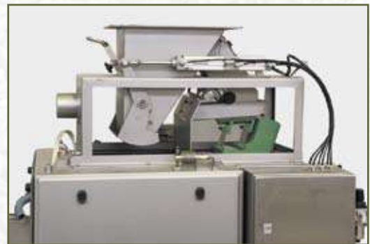
Dosage mixte (gravité + couloir vibrant) Kombinierte Dosierung (Klappeneinlauf + Vibrationsrinueinlauf)
